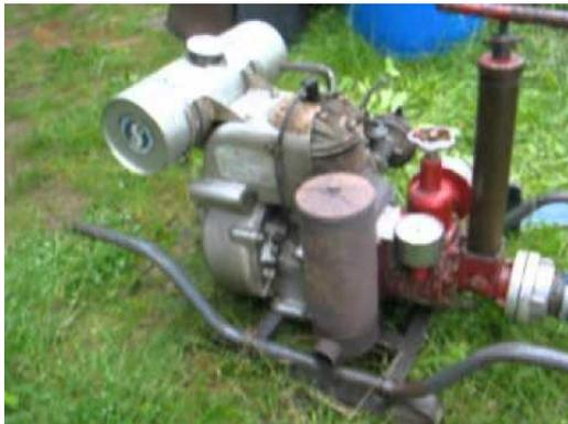
Abbildung 18 Tragkraftspritze Ziegler TS 4<sup>56</sup>
