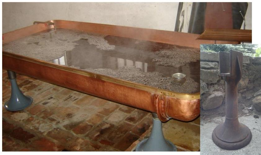
Abbildung 5 Beispiel eines „Kühlschiffs“ zur Würzeklärung und -kühlung. Rechts ein aus dem Brauereibrand übrig gebliebener Fuß für das Kühlschiff der ehemaligen Brauerei in Weildorf.
